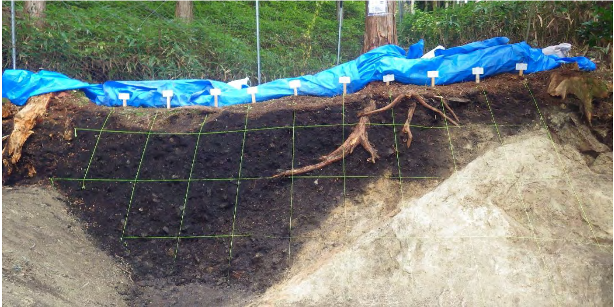
図 作業道の法面整形と掘削によって現れた断層露頭。
