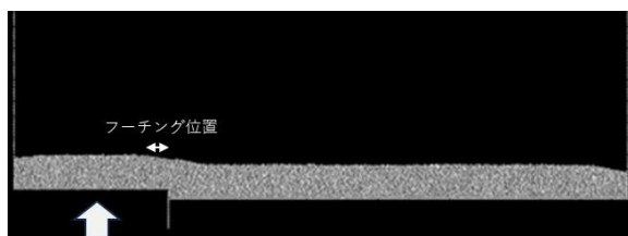
図 2 フーチング幅 15cm の解析結果
