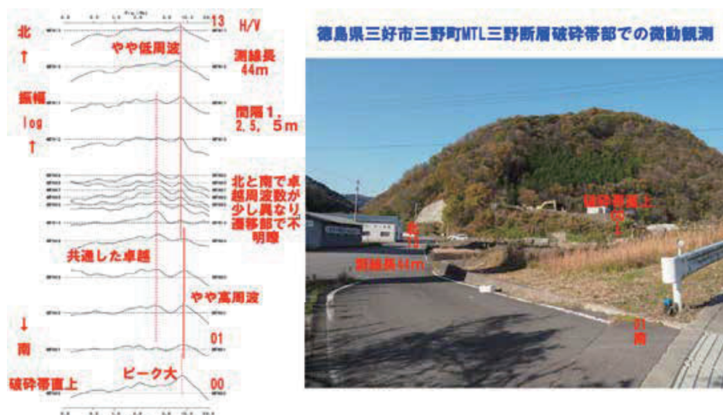
図-1 左：断層破碎帯直上(00)と道路上で実施した(01～13)常時微動 H/V スペクトルと右：現地写真 10Hz 付近のピークが破碎帯を挟んで少し変化し、直上付近で不明瞭になっている。
