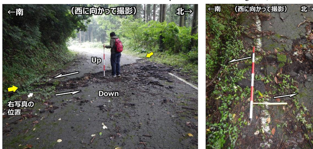
図2 P6 で確認した地表地震断層。走向 N84° W、上下変位量 15cm（北落ち）、左横ずれ 10cm。
