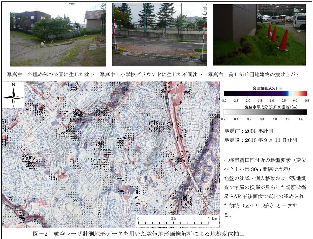
図-2 航空レーザ計測地形データを用いた数値地形画像解析による地盤変位抽出
