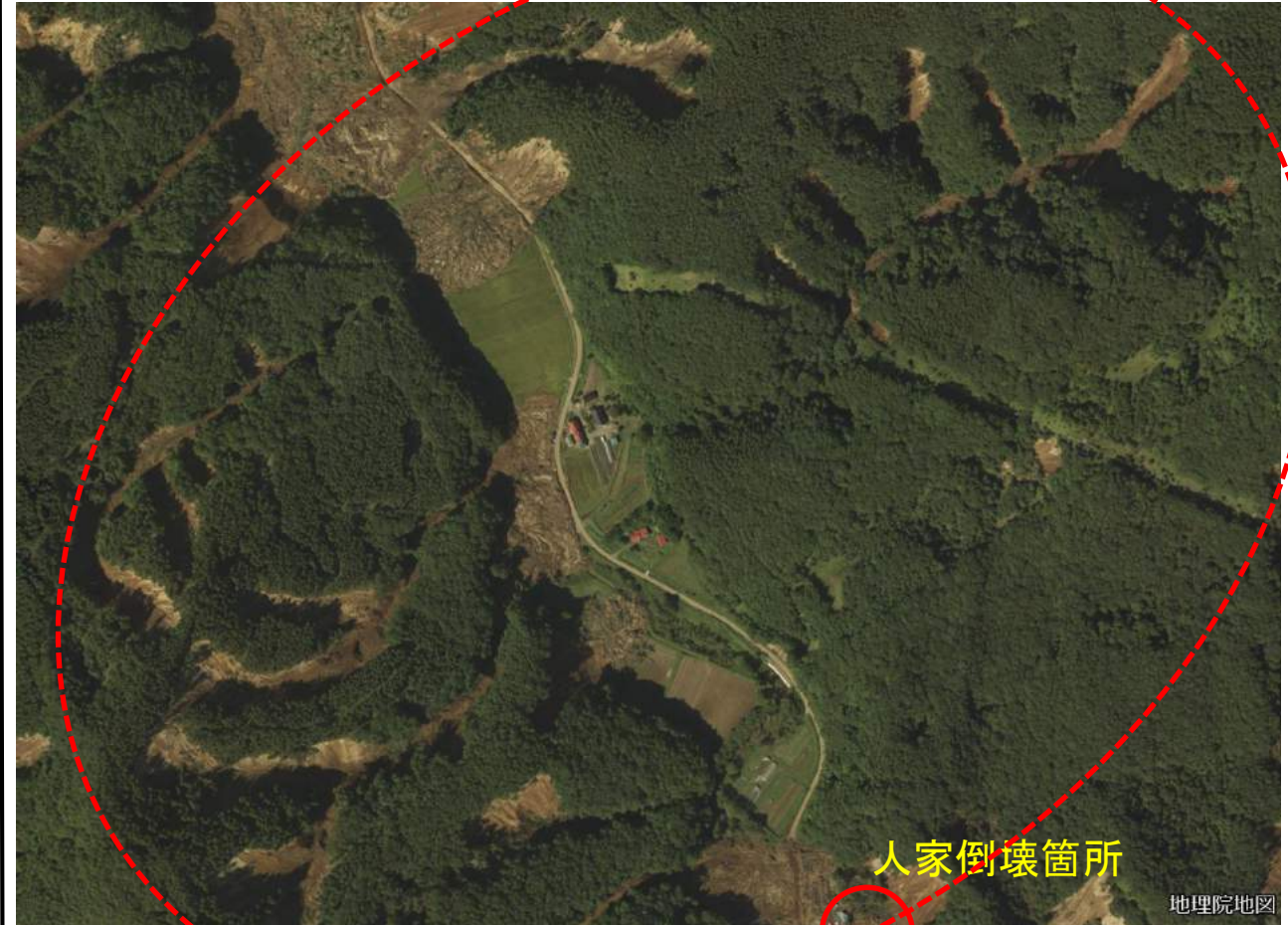
西岸側G崩壊・地すべり箇所:平滑斜面の崩落型に近いもの、浅谷崩壊・地すべり型、沢収斂で沢口で狭まり低地で拡散型など様々なタイプが展開する。
