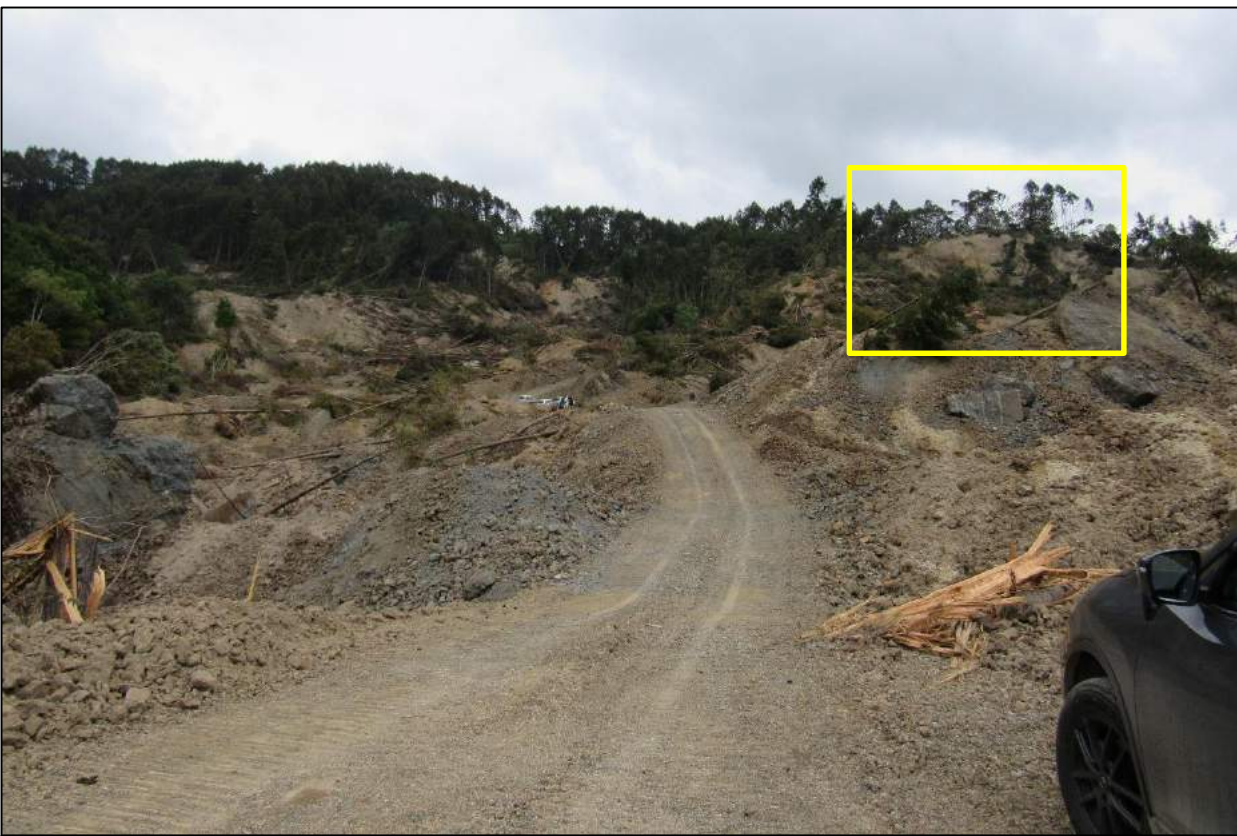
谷を塞ぐように押し出された大規模地すべりブロック(西から撮影)。手前は谷下流部へもたらされた土砂・岩塊。
